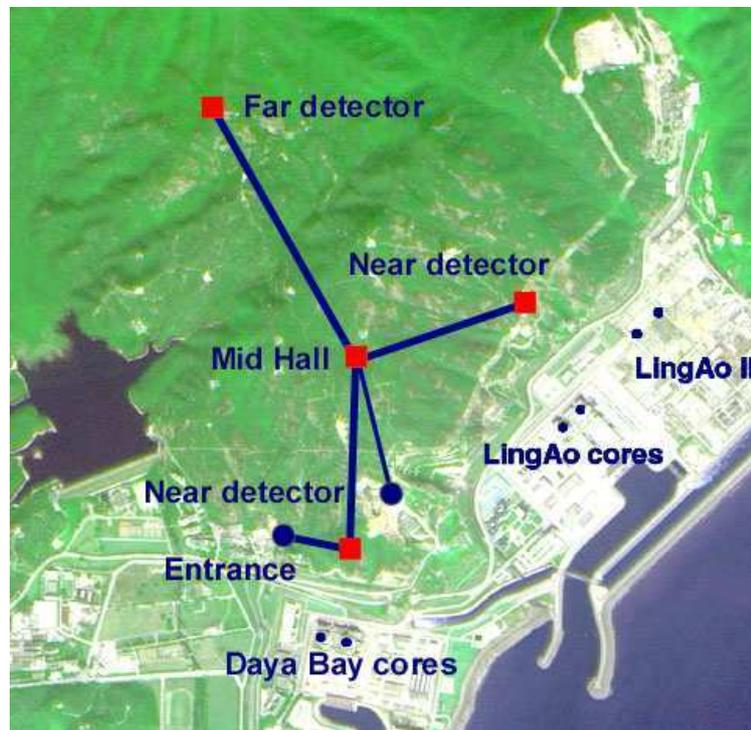
Рис. 3.4: Схема проведения эксперимента DayaBay.
